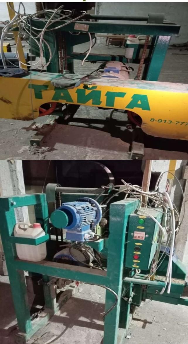
Ленточная пилорама Тайга Т1М является малогабаритной пилорамой с электроприводом, предназначенной для распиловки бревен на брус, лафет, обрезную и необрезную доски и так далее.
