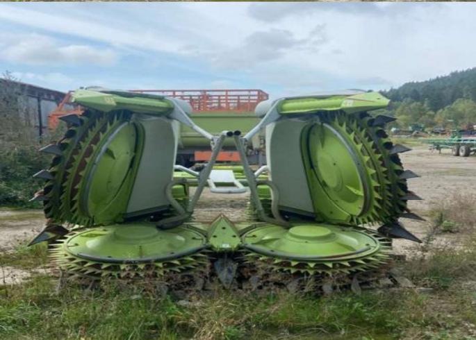
Жатка для уборки кукурузы ORBIS 600 отличается наличием больших и малых дисков для оптимального потока массы, высокой производительностью, а также эксплуатационной надежностью. Маятниковая концепция рамы с измененной конструкцией Т-образных панелей уменьшает вес приставки и увеличивает ее износостойкость. Новейшая же система складывания приставки в считанные секунды переводит ее из рабочего в транспортное положение и обратно.
